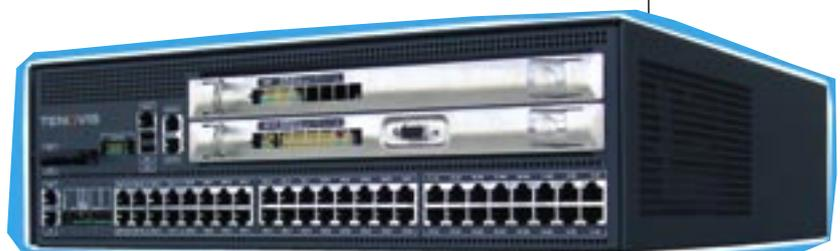
Zentrale Funktionen wie die Vermittlungssteuerung zum Beispiel werden gedoppelt auf unterschiedliche Module angeordnet, die auch räumlich voneinander getrennt sein können. Zusätzlich können systemkritische Komponenten wie Netzteile innerhalb der Baugruppenrahmen redundant ausgeführt werden.
